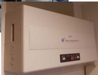
5.5kWh対応のパワーコンディショナー
